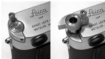
ライカM3、M2、M1、MP6の巻き戻しノブに差し込んでネジ止めすると、クランク式となり巻き戻しが楽になるアクセサリ。撮影時は写
