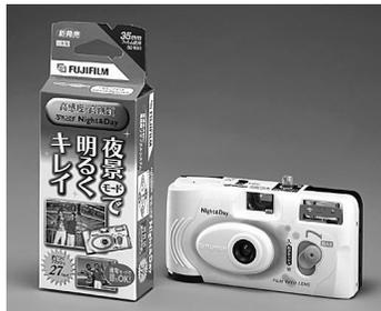
ISO 1600のフィルムを採用し、絞りとシャッター速度を切り替えできる夜景モードを搭載したレンズ付フィルム。通常撮影では絞りF14・1/120秒だが、夜景モードでは、絞りF6.2・1/45秒に切り替わり、背景もきれいに写し込める。レンズは片面非球面レンズを2枚使用。
