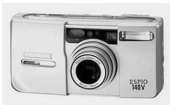
38 ~ 140mm の 3.7 倍ズームレンズを搭載した 35mm コンパクトカメラ。非球面レンズ 2 枚や独自のレンズ構成により小型化と高倍率化を達成している。レンズは 6 群 8 枚構成の smc ペンタックスレンズ。AF は 5 点測距のパッシブ方式。また近接時にストロボの発光量を調節し、白飛びを軽減するソフトフラッシュ機能を備えている。
