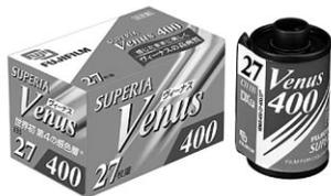
従来品より、受光感度を30%アップさせ、粒状性を良くした高感度カラーネガフィルム。ISO 400と800、1600の3種類。乳剤をより薄く、形を整えることで、感度アップなどを図っている。またスーパーエフィシエントカラー技術による新規イエローカラーを採用、現像時の発色効率を高めている。
